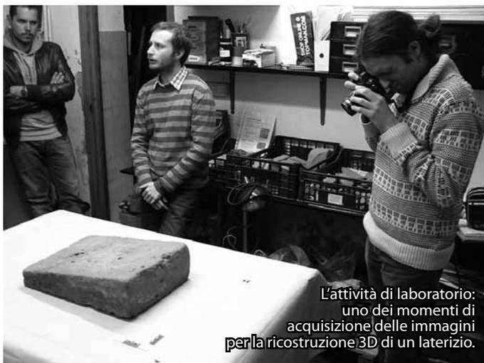
L'attività di laboratorio: uno dei momenti di acquisizione delle immagini per la ricostruzione 3D di un laterizio.
